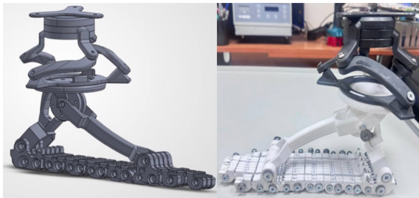
Рис. 3. а) CAD-сборка голеностопного сустава с опорной гусеничной платформой; б) физический прототип голеностопного сустава, изготовленный методом FDM 3D-печати
